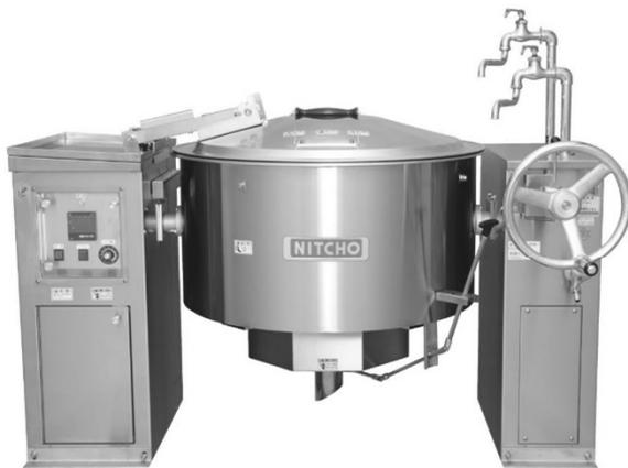
東北電力(株)様との共同開発製品である内釜ステンレス電気回転釜は、これ1台で「汁物」「炒め物」「煮物」「茹で物」「蒸し物」などの幅広い調理が可能です。「学校給食施設」「病院・福祉施設」などの大量調理施設で大活躍します。電気式なので排熱が少なく、作業環境の改善が見込めます。また、空調などのランニングコスト低減も図れます。デジタル制御のヒーターにより細かい温度調整が可能で、作業のマニュアル化が図りやすく、料理の仕上がりも安定します。内釜がステンレスなので腐食しにくく、耐久性に優れ、お手入れも容易です。
